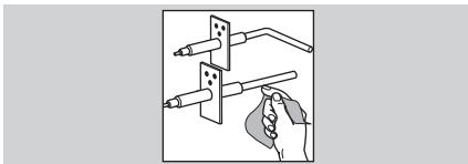
**18** Проверьте электроды и фарфоровые изоляторы на предмет термических трещин и при наличии повреждений замените электроды.
