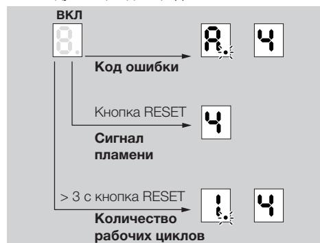
Код ошибки: ошибка немедленно отображается в виде буквы и цифры, сменяющих друг друга на дисплее, и сигнализирует о предупреждении или неисправности, см. стр. 11 (Помощь при неисправностях).
